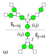
$$E_{ij}^{(t+1)}(I_{ij}) = \min_{I_{ki}|R_i=0} \left[ |I_{ij}|^{\alpha} + \sum_{k \neq j \in N_i} E_{ki}^{(t)}(I_{ki}) \right]$$
